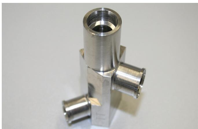
Fittingbausatz - aus Vollmaterial gefräst
