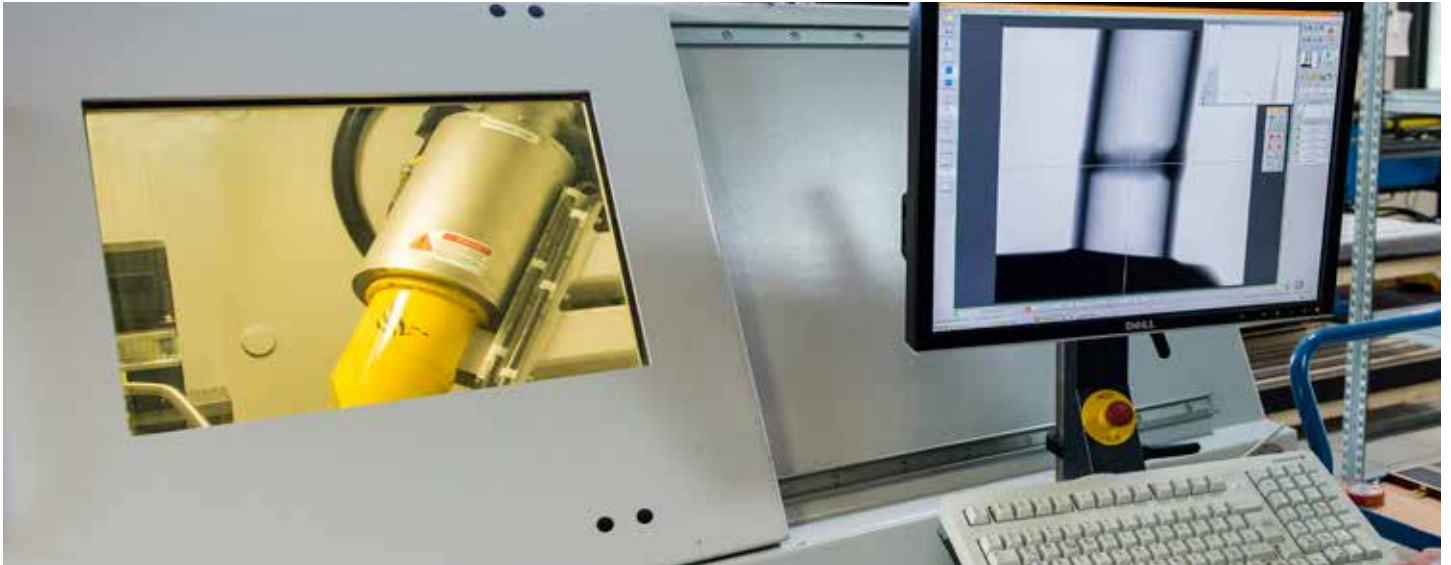
RT und CT 3D Röntgen im Hause TUBE-TEC durch externen Dienstleister
