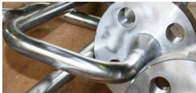
Einsparung der Schweißnähte durch einteilige Biegung
