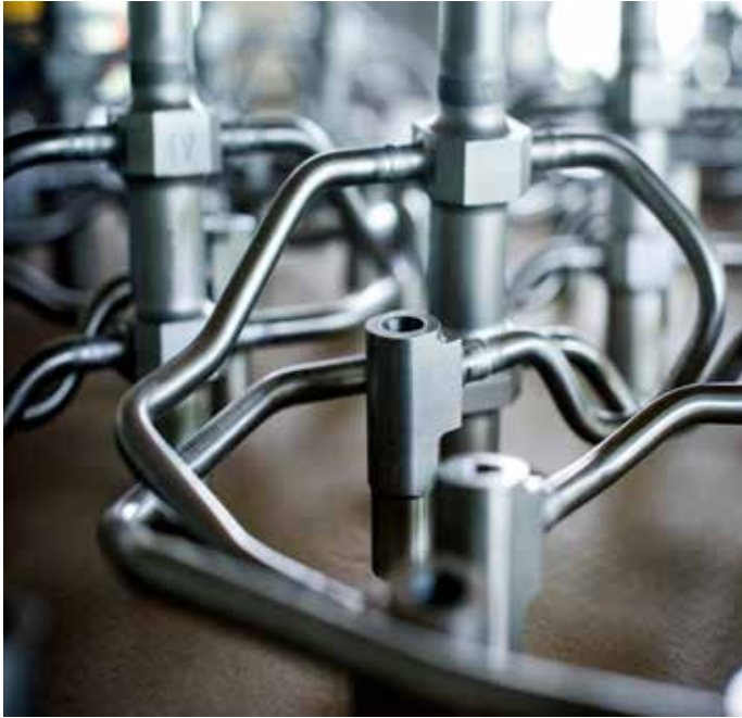
Rohrbiegungen mit angeschweißten Fittings
